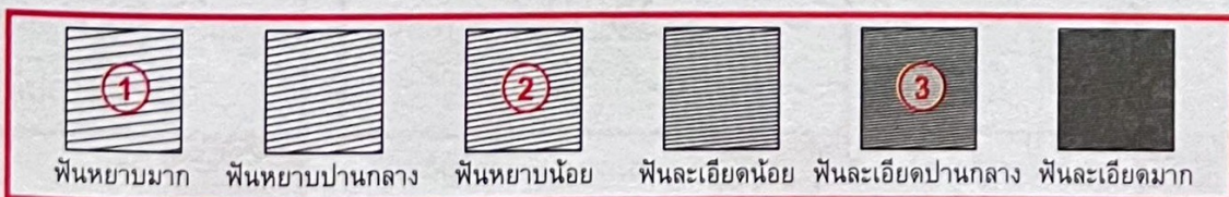
รูปที่ 4.15 ชนิดของฟันตะไบแบ่งเป็น 3 ชนิด เปรียบเทียบกับแบบแบ่งเป็น 6 ชนิด
