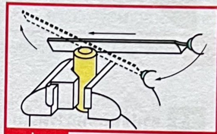
รูปที่ 4.46 การตะไบลบมุม 45 องศา
