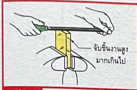
รูปที่ 4.30 การจับชิ้นงานที่สูงเกินไป
