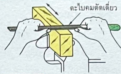
รูปที่ 4.25 การจับตะไบเพื่อการขุดหรือการไสตะไบ
