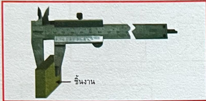
รูปที่ 4.50 การตรวจสอบขนาดชิ้นงานด้วยเวอร์เนียคาลิเปอร์
