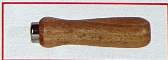
รูปที่ 4.2 ด้ามตะไบที่ทำด้วยไม้
