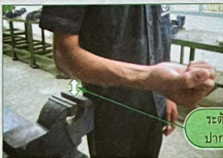
รูปที่ 4.27 ระดับความสูงของปากกาจับชิ้นงานที่เหมาะสม
