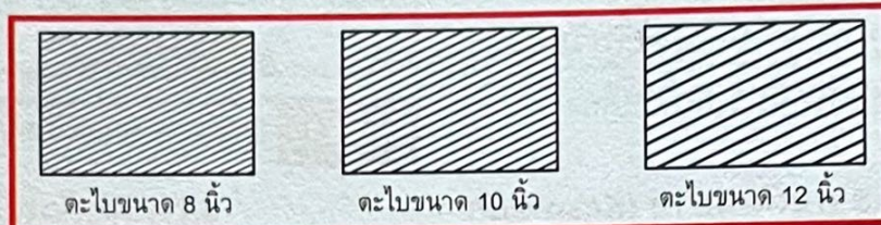
รูปที่ 4.16 เปรียบเทียบความละเอียด ความหยาบของฟันตะไบที่มีความยาวแตกต่างกัน
